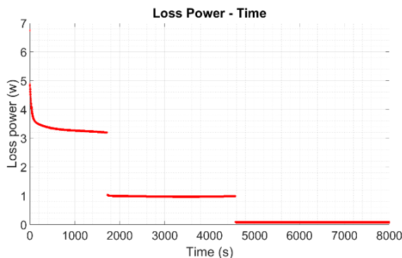
شکل ۱۲: تلفات اهمی ناشی از شارژ باتری با شیوه جریان ثابت چندمرحله‌ای (شبیه‌سازی دوم).
