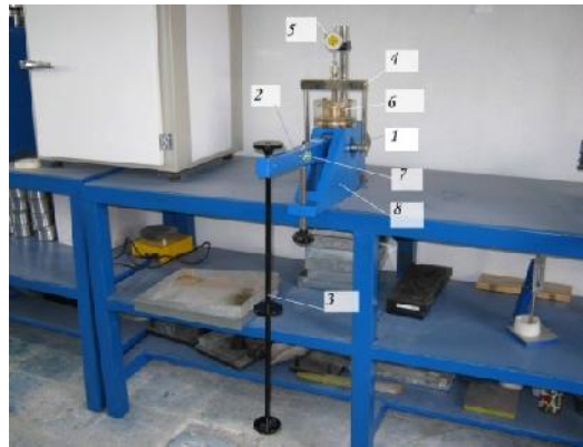
شکل (۲): نمای کلی دستگاه ادنومتر استفاده شده در این تحقیق
