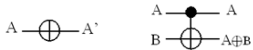
شکل ۵: نمایش دروازه های پایه کوانتومی NOT و CNOT با هزینه کوانتومی واحد.
