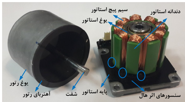
شکل ۷: موتور آهن ربای دایم ساخته شده.
