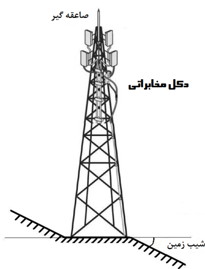
شکل ۱۱: دکل مخابراتی نصب‌شده در سطح شیب‌دار.
