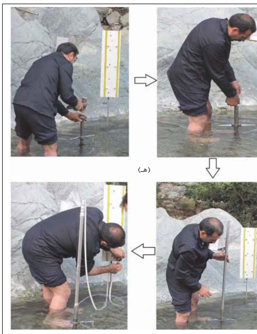
شکل ۳. مکانیسم نصب مینی پیزومتر الف) ضربه زدن به لوله جدار و میله محرک به طور هم زمان از طریق یک محافظ چکشی و وارد کردن آن به داخل بستر رودخانه، ب) میله محرک فولادی خارج می شود ولی جدار محافظ قرار گرفته در محل نگه داشته می شود، ج) مینی پیزومتر به داخل لوله جدار وارد می شود، د) مینی پیزومتر در محل نگه داشته می شود در حالی که لوله جدار به طرف بالا کشیده می شود (Baxter et al., 2003)، ه) برقراری اتصالات مانومتر ساخته شده در رودخانه سولقان تهران
