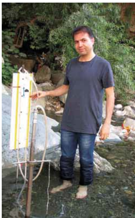
شکل ۶. مینی پیزومتر نصب شده در رودخانه سولقان تهران و تعیین جهت جریان (رودخانه دهنده) و اختلاف بار هیدرولیکی رودخانه و آب زیرزمینی (dh)
