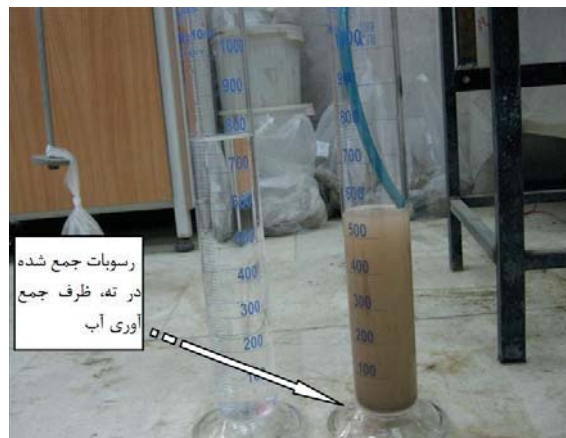
شکل ۷. تفاوت رنگ آب جمع شده در ظرف جمع‌آوری آب و همچنین ته‌نشست لایه‌ای از رسوبات در ته ظرف در آزمایش پین‌هول (Pinhole).
