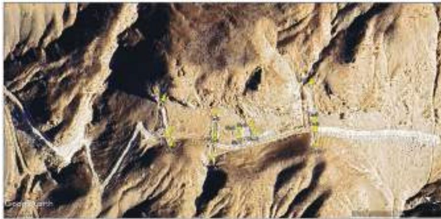
شکل ۸. جاده دسترسی، سینه‌کار و ترانشه‌های اکتشافی ایجاد شده در کانسار گچ دربر روی تصویر Google Earth
