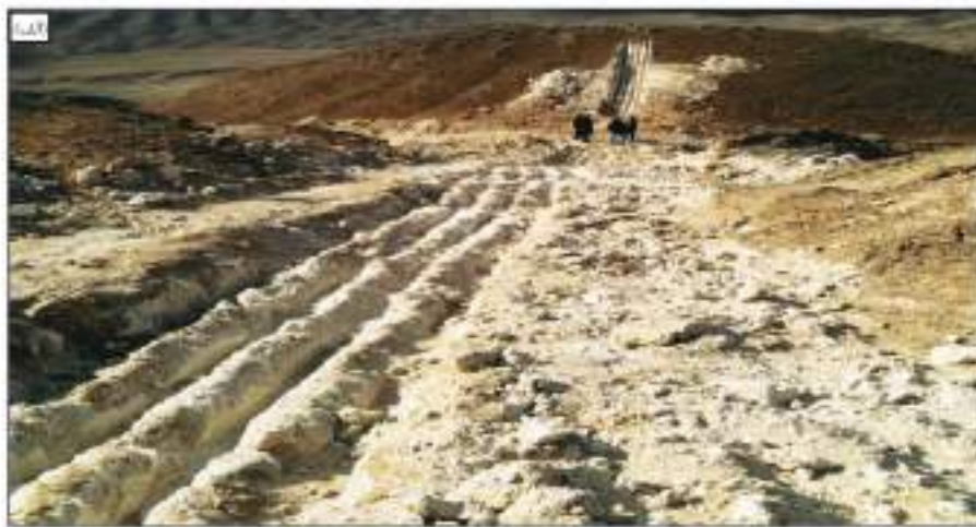
شکل ۸. جاده دسترسی، سینه‌کار و ترانشه‌های اکتشافی ایجاد شده در کانسار گچ دربر روی تصویر Google Earth
