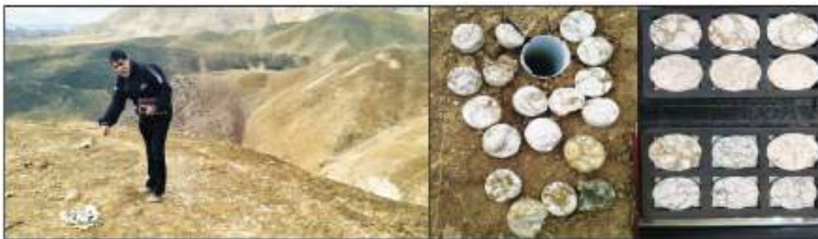
شکل ۱۱. موقعیت دهانه گمانه اکتشافی و چندتکه از مغزه‌های حاصل از حفاری
