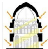
نحوه ورود نور به فضای زیر گنبد مسجد الغدير و گنبدخانه مساجد سستی ایران
