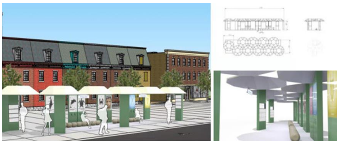
شکل ۶ طراحی صفحات خورشیدی ابریشم گرافن که در ایستگاه های اتوبوس هوشمند اعمال می شود.
