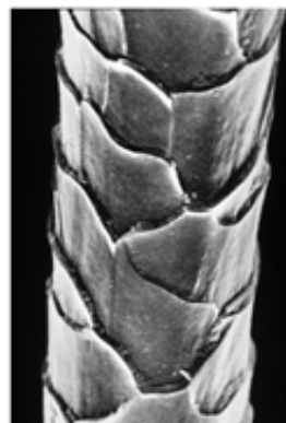
شکل ۲ تصویر میکروسکوب الکترونی روبشی از لیف پشم مریوس تمیز [۳].
