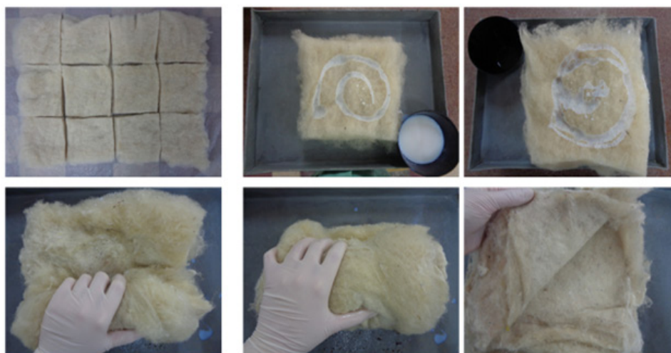
شکل ۴ مراحل ساخت نمونه‌های پشم عایق صوتی [۱۶].
