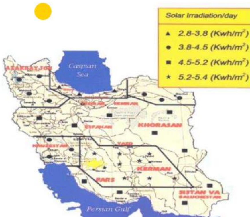
شکل ۱۱ نقشه میزان انرژی تابشی خورشیدی کل که در طول سال در نقاط مختلف ایران منبع (۴۶)
