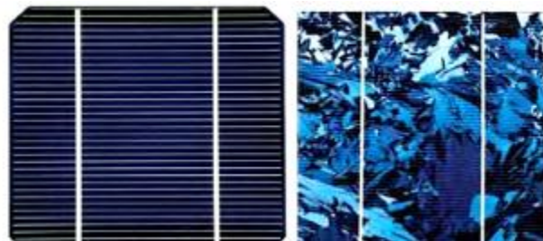
شکل ۷: سلول خورشیدی سیلیکونی تک‌بلوری و چند بلوری
