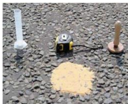
شکل ۵ آزمایش پخش ماسه (fwa,2006)
