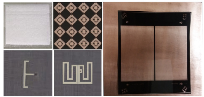
شکل ۳: نمونه‌های پیاده‌سازی شده آنتن و سطح AMC.
