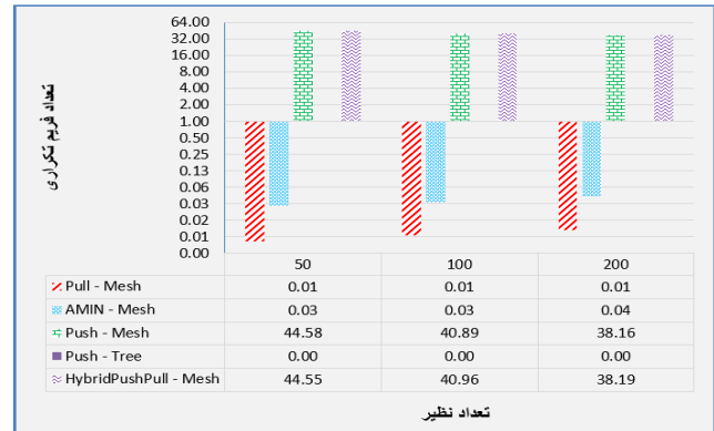
شکل ۱۶: تعداد فریم‌های تکراری دریافتی در روش‌های مختلف شبیه‌سازی شده بر حسب تعداد نظیرها.
