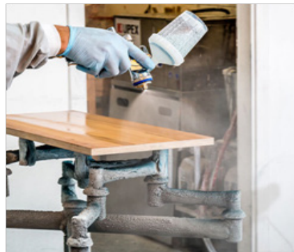
شکل ۱۴ روکش صنعتی مناسب برای چوب از جنس هیبریدهای پلی یورتان پایه آبی / آکریلات [۲۸]
