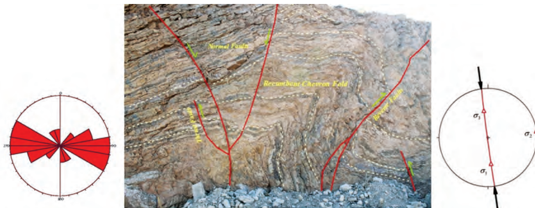
شکل ۱۰. الگوی یک چین جناغی خوابیده که هر دو یال آن به وسیله گسل نرمال (در یال بالایی) و گسل معکوس (در یال پایینی) بریده شده است (دید به سمت جنوب باختر)
