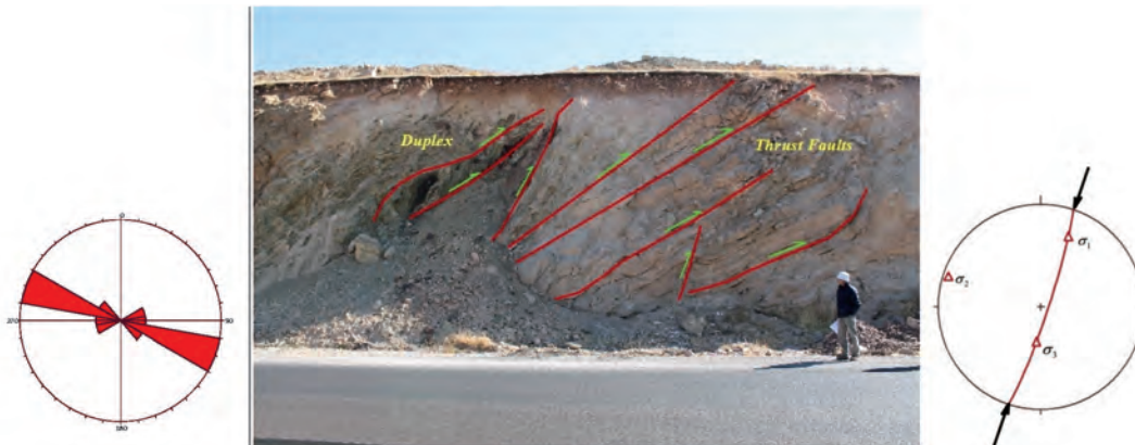
شکل ۵. شدت دگرشکلی در لایه‌های شیلی-رادیولاریتی به همراه نمودار گل سرخی و استریوگرام آن (دید به سمت جنوب باختر)
