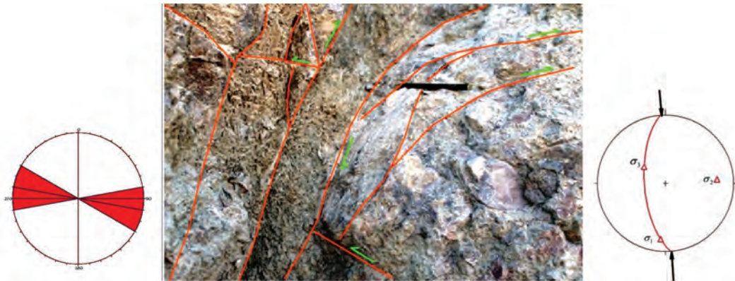
شکل ۴. سطوح گسل‌های راندگی و معکوس بزرگ زاویه عمود بر هم به همراه نمودار گل سرخی و استریوگرام آن (دید به سمت جنوب)
