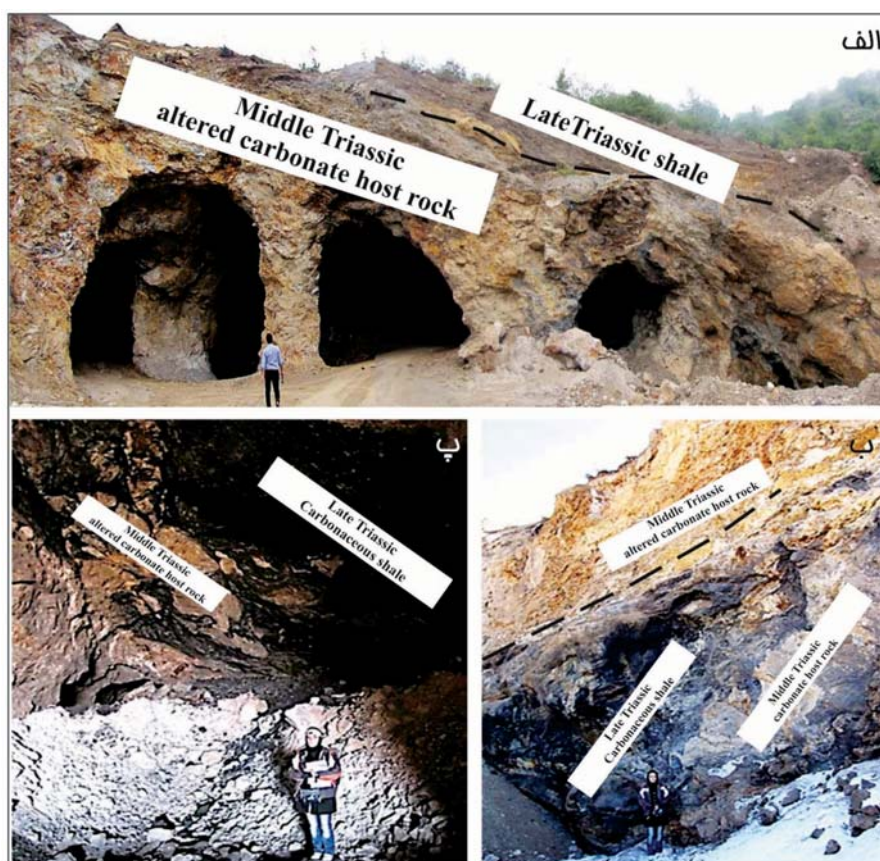
شکل ۲. تصاویری از جبهه کارهای فعال معدن کمپریش در سنگ میزبان کربناته سازنده الیکا در تماس نزدیک با واحدهای شیل زغال دار سازنده شمشک
