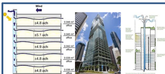
شکل ۱۹- سیستم تهویه طبیعی برج کپیتاگرین در سنگاپور
