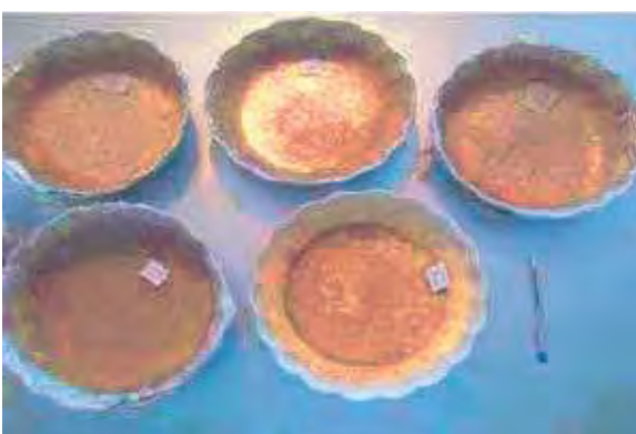
شکل ۲. غبار ریزشی جمع شده در پایان یک دوره نمونه‌برداری پس از تخلیه تیل‌ها از ظروف پلاستیکی
