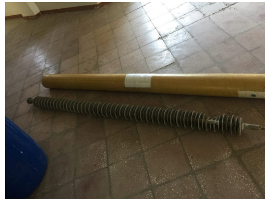
شکل ۲: مقره ۲۳۰ kV باز شده از خط انتقال در نزدیکی نیروگاه آبادان از کانون شماره ۲.
