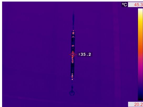
شکل ۱۷: تصویر ثبت شده توسط دوربین ترموویژن - مفره آلوده شده در حالت پاشش آب.
