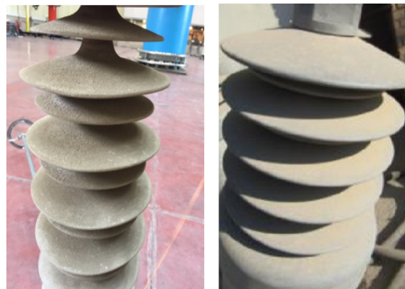
شکل ۶: مقره 230 \text{ کیلوولت} با (الف) آلودگی طبیعی و (ب) آلودگی مصنوعی.
