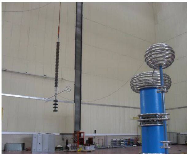
شکل ۷: تصویر ست‌آپ آزمایش جریان نشتی.
