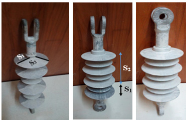
شکل ۳: نمایی از استقرار آلودگی بر سطح مقره‌ها، (الف) آلودگی یکنواخت، (ب) آلودگی غیر یکنواخت طولی و (ج) آلودگی غیر یکنواخت قطاعی.
