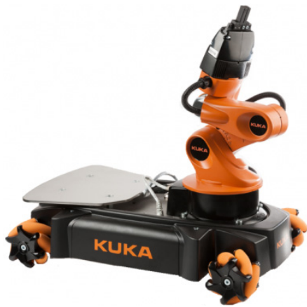
شکل ۱۰: ربات بازویی متحرک KUKA youBot مورد استفاده در تحقیق.
