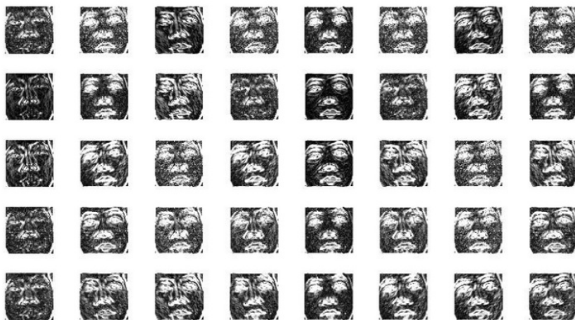
شکل ۱۱: بهترین بانک فیلتر گابور در روش پیشنهادی بعد از تنظیم دقیق پارامترهای سیگما و گاما با مقداردهی پارامترها به صورت f = \pi / (2\sqrt{2}) : \pi / (2\sqrt{2}) , \gamma = 1 , \sigma = 0.4 , \theta = 0 : 7\pi/8 .
