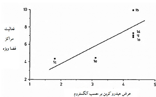
شکل ۲ اثر عرض هیدروکربن متصل به اتم سیلان بر فعالیت مراکز فضاویژه [۱۳].
