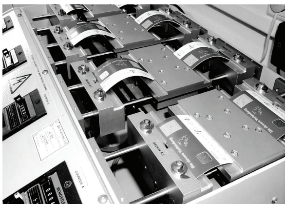
شکل ۲ دستگاهی برای انجام آزمون‌های خمشی دینامیک روی کارت‌های هوشمند [۲].
