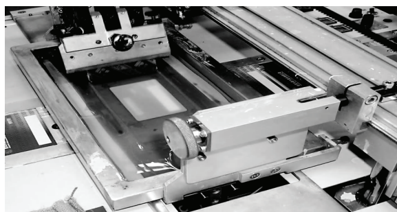
شکل ۱۲ دستگاه چاپ اسکرین به روش تک کارت [۲].
