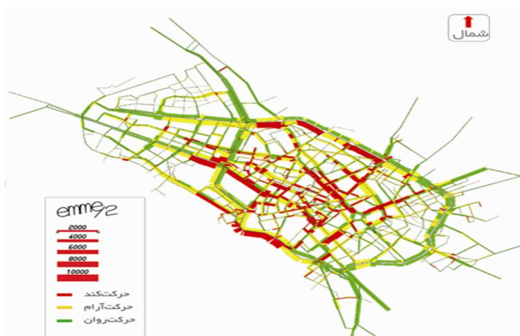
شکل (3) کیلومترهایی که هر وسیله نقلیه در محدوده هر منطقه ز منتخب سفر کرده (VKTj)
