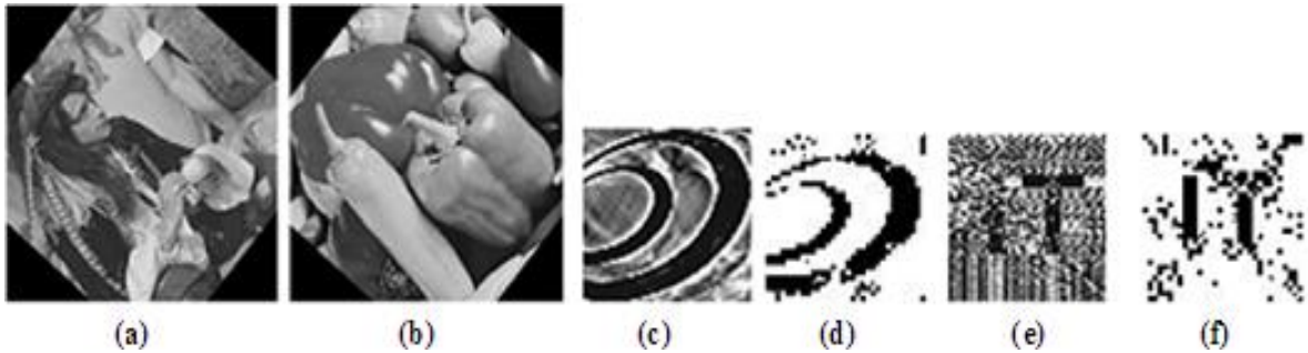
شکل ۱۱: (b) تصاویر نشانه‌گذاری شده بعد از چرخش تصویر (e) نشانه‌های استخراج شده به روش [۹] (f) نشانه‌های استخراج شده به روش پیشنهادی
