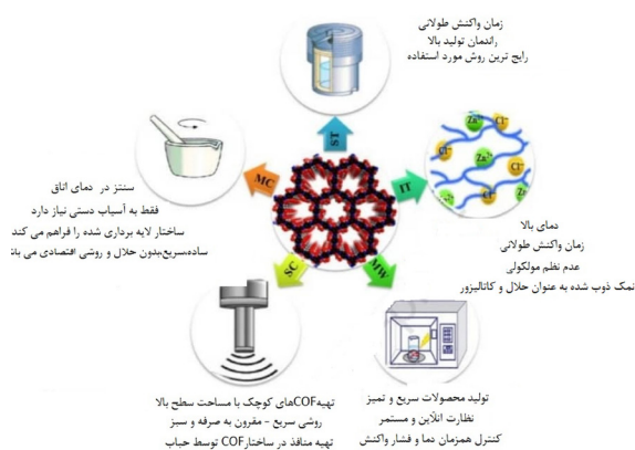
شکل ۱ طرح‌واره خواص و مزایای روش‌های مختلف (MC و ST، IT، MW، SC) برای ساخت COFها.
