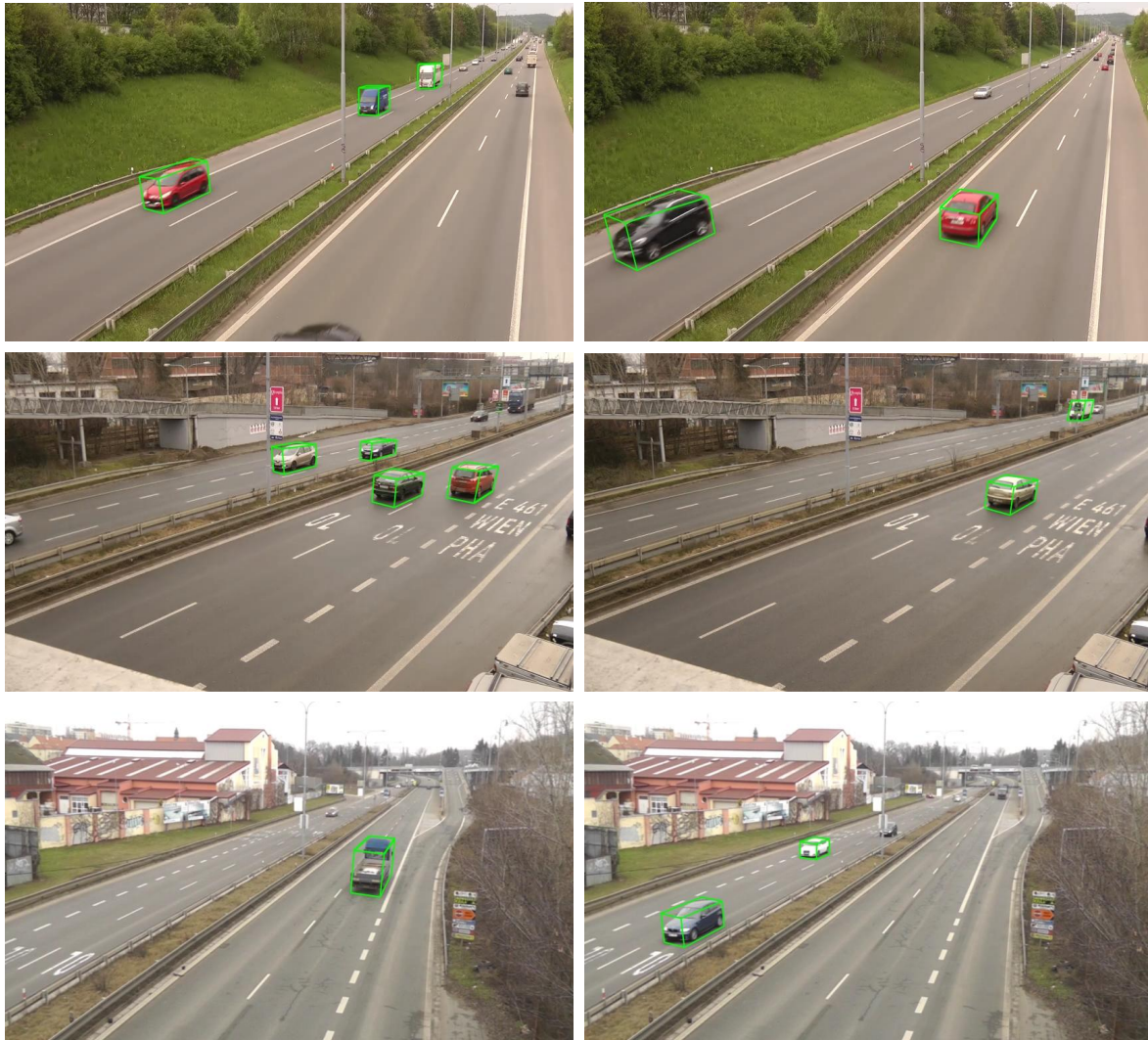
شکل ۱۲: پاسخ روش پیشنهادی در شناسایی محدوده دقیق خودروها.
