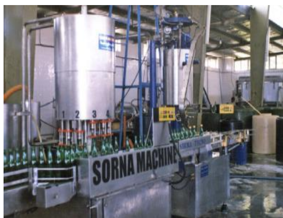
شکل ۵. ساخت پنج دستگاه پرکن مایعات (مرکز فارس، ۱۳۷۷)
