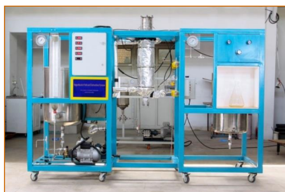
شکل ۱۵. فناوری حلال‌های فوق داغ (مقیاس پایلوت) ۲-۶- طراحی و راه اندازی مراکز آزمون و تحقیقات تجهیزات انرژی‌بر
